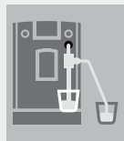
RINÇAGE DE LA BUSE VAPEUR
